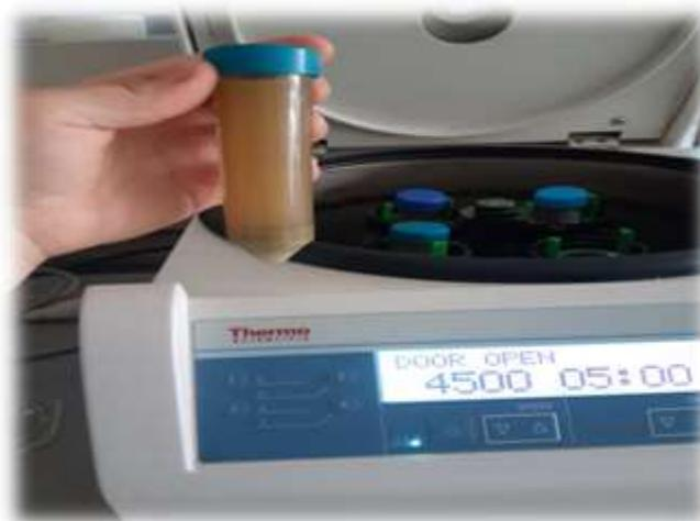
**Figure II- 5** : la centrifugation de surnageant.
