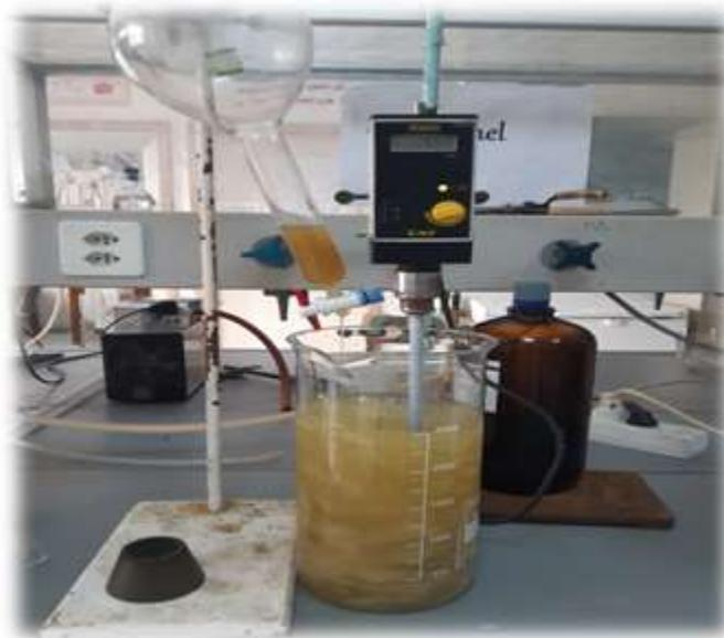
**Figure II- 6 :** précipitation dans l'éthanol.
