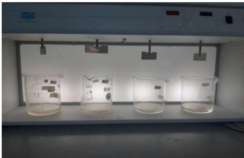
**Figure III- 1 : Jar-test.**
