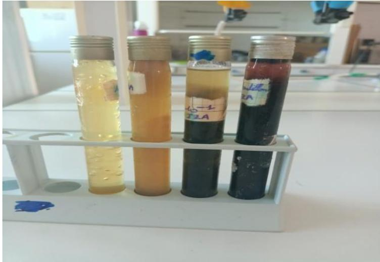
**Figure.III.17:** Représentation des tubes correspondant à la recherche et dénombrement des spores sulfito-réductrices
