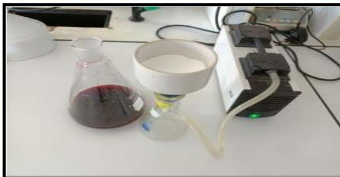
Figure. II.7 : montage de filtration avec une pompe électrique.
