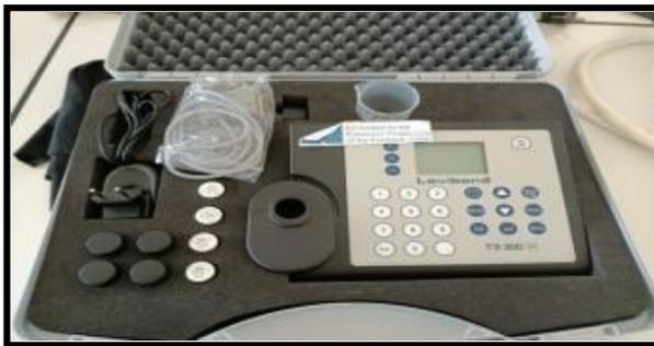
Figure. II.6 : L'appareil TB 300 IR pour mesure la turbidité.
