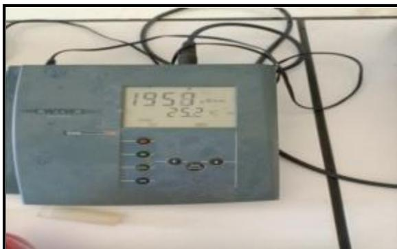
**Figure. II.5 :** Conductimètre (WTW inolab cond-7110).
