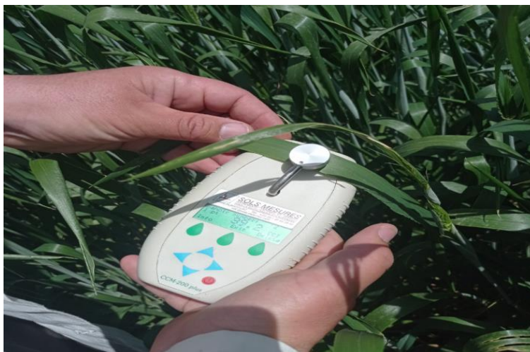
Photo 01 : Mesure de la teneur en chlorophylle des feuilles par le chlorophylle-mètre portable, type CCM-200.
