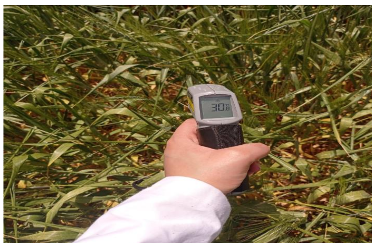
Photo 02 : Lecture de la température du couvert végétal par le thermomètre portable, à infrarouge.
