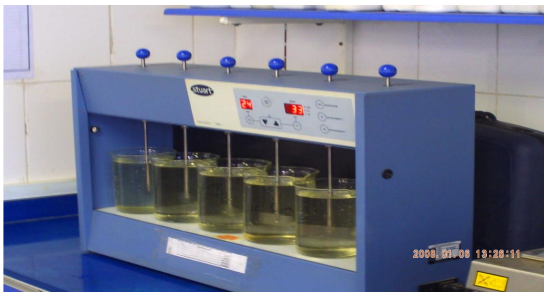
Figure 14 : Jar test Flocculateurs
