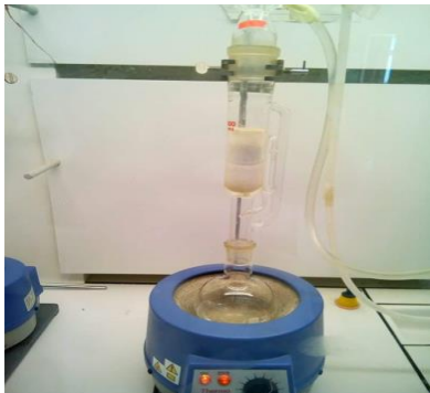
L'extraction par Soxhlet
