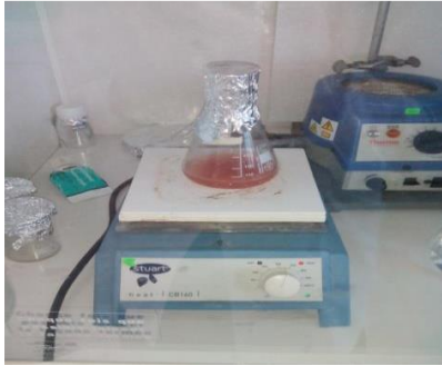
L'ébullition de l'échantillon
