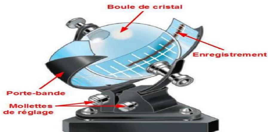
*Figure II.8* : Schéma d'un héliographe de Campbell-Stokes.
