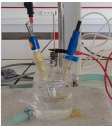
*Figure II.2: Cellule électrochimique à trois électrodes.*
