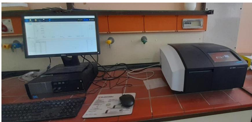
Figure II.12 : spectromètre UV-visible.
