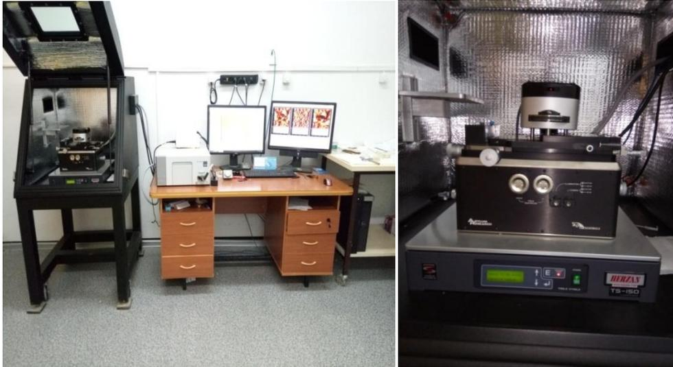
Figure II.17: Microscope à force atomique AFM de type MFP-3D Classique.
