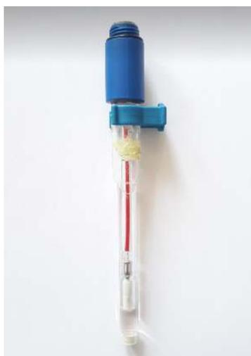
**Figure II-7:** Electrode au calomel saturé (ECS) utilisée pendant nos expériences.
