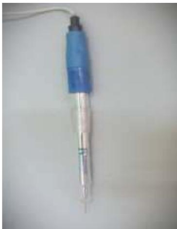
**Figure II-6 :** Electrode auxiliaire en platine utilisée au laboratoire.
