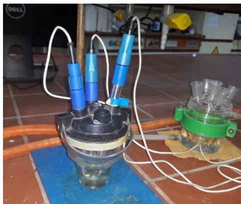
**Figure II-4:** Cellule à trois électrodes utilisées au laboratoire.
