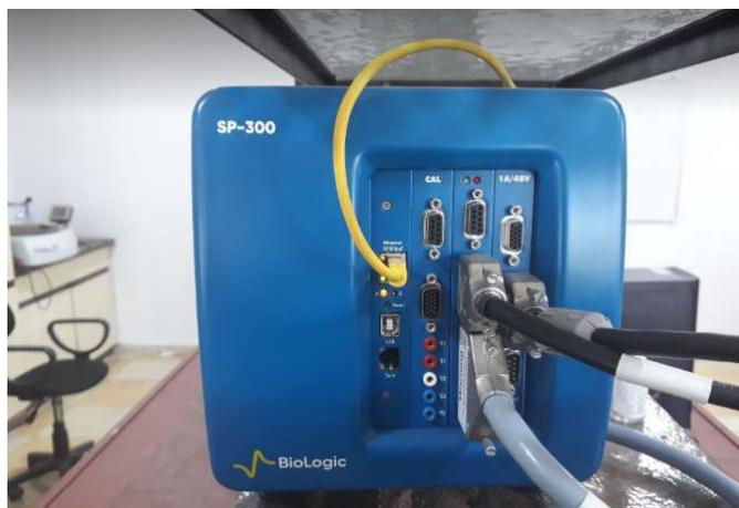
Figure II-8: EC-Lab SP300 utilisé au laboratoire pour la réalisation de nos dépôt.
