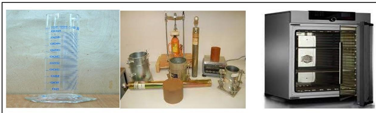
Figure 44 Matériel de confection des éprouvettes d'essai Proctor normal.
