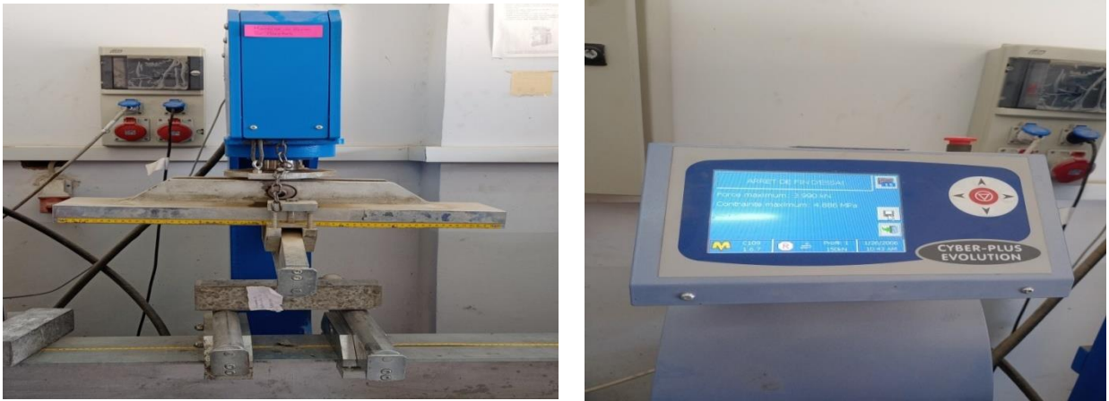
Figure III.17. L'essai de la résistance à la traction par flexion (laboratoire GC)
