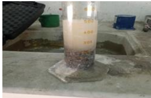
Figure III.5. Essais masse volumique apparent et absolue de gravier
