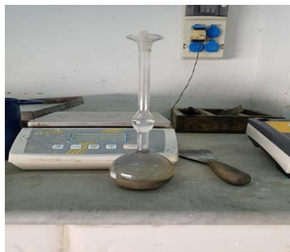
Figure III.7. Essai de la masse volumique absolue du ciment
