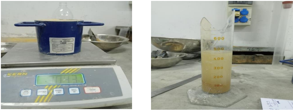
Figure III.2. Masses volumique apparente et absolue du sable
