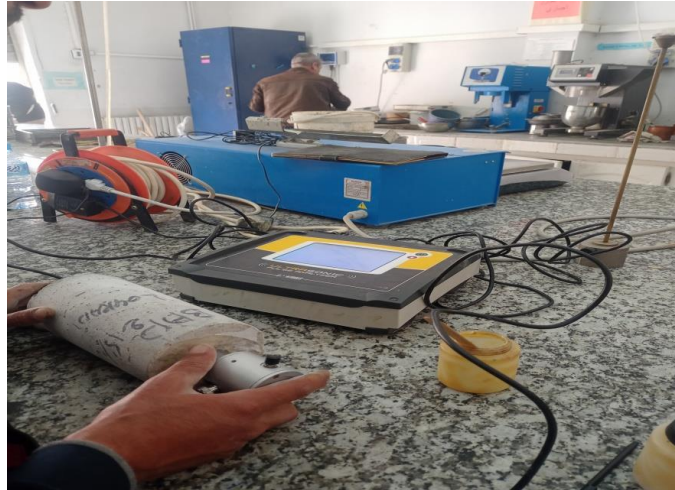
Figure III.18. L'essai d'ultrason (laboratoire GC)
