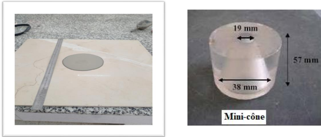
Figure. III.9. Détermination du point de saturation au mini cône
