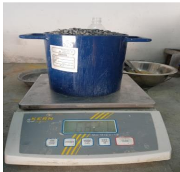
Figure III.5. Essais masse volumique apparent et absolue de gravier
