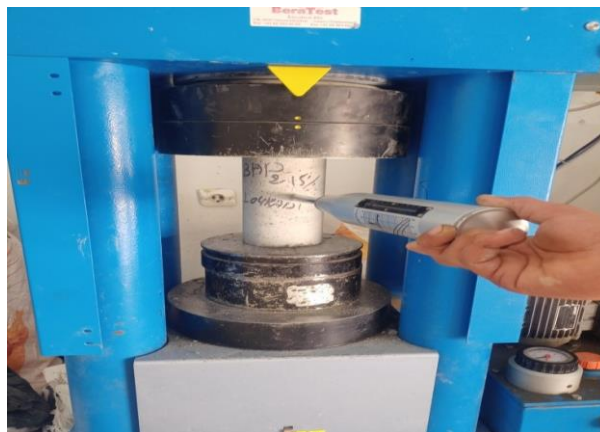
Figure III.19. L'essai de scléromètre (laboratoire GC)
