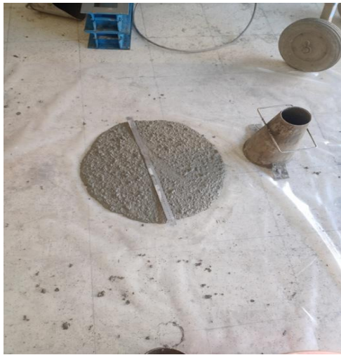
Figure III.10. L'essai d'étalement (laboratoire de génie civil).
