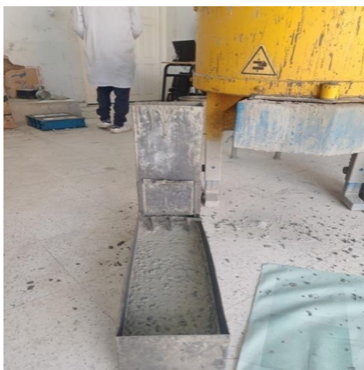
Figure III.11. L'essai de la boîte en L (laboratoire de GC).
