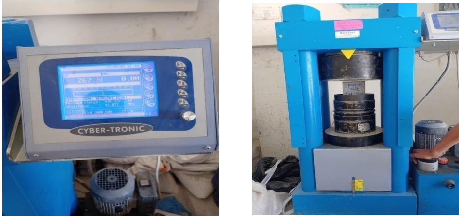
Figure III.16. L'essai de compression (au laboratoire GC)
