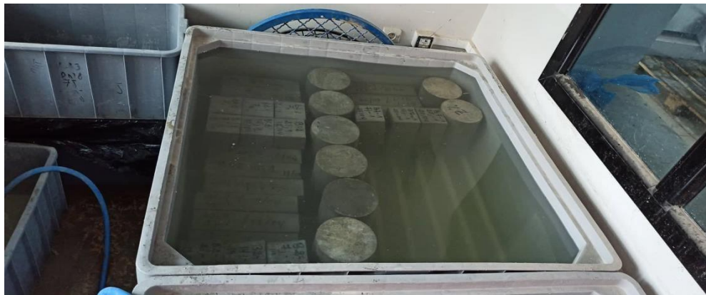
Figure III.15. Bac de conservation des éprouvettes (laboratoire GC)
