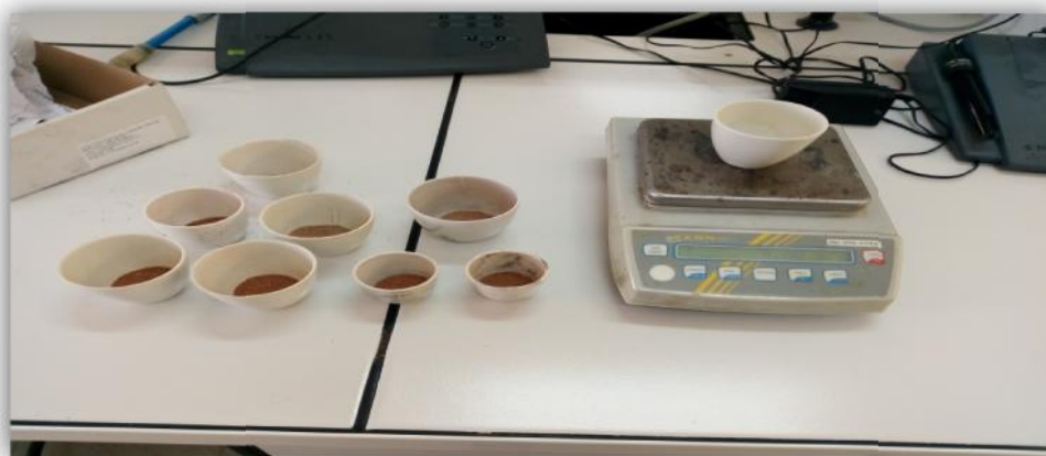
Figure 16: Image représentative la méthode détermination la MO.
