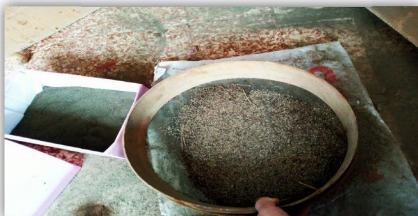
Figure 12: Tamisage des échantillons.
