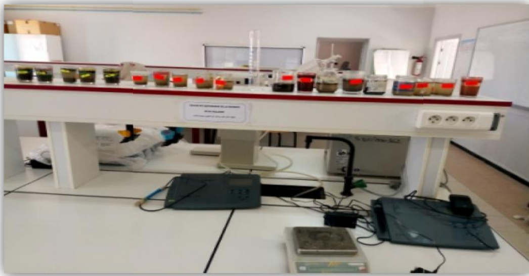
Figure14 : Détermination la conductivité électrique d'un sol.
