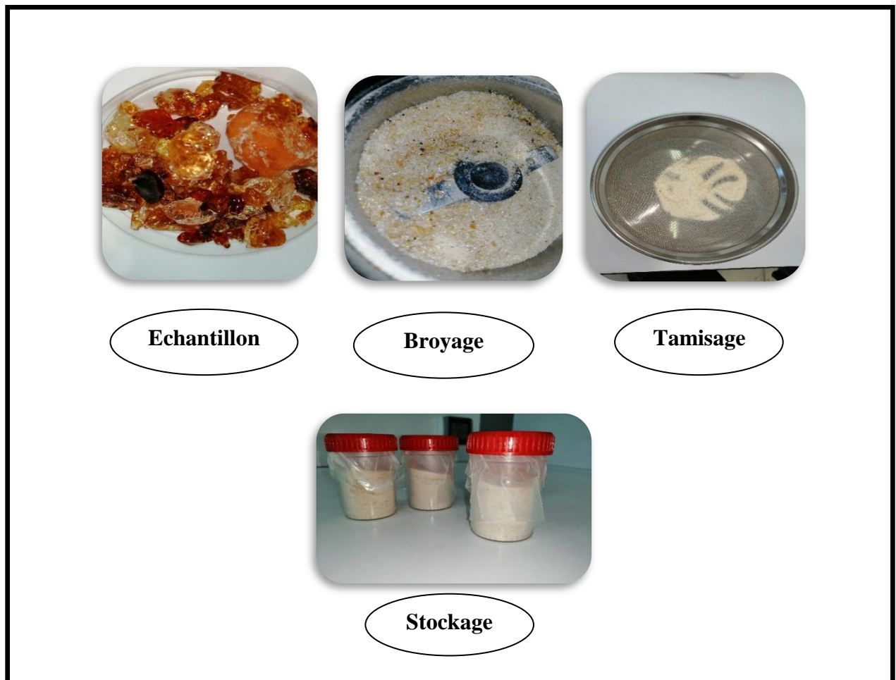
Figure 1 : Étapes de préparation de la poudre de la gomme arabique.
