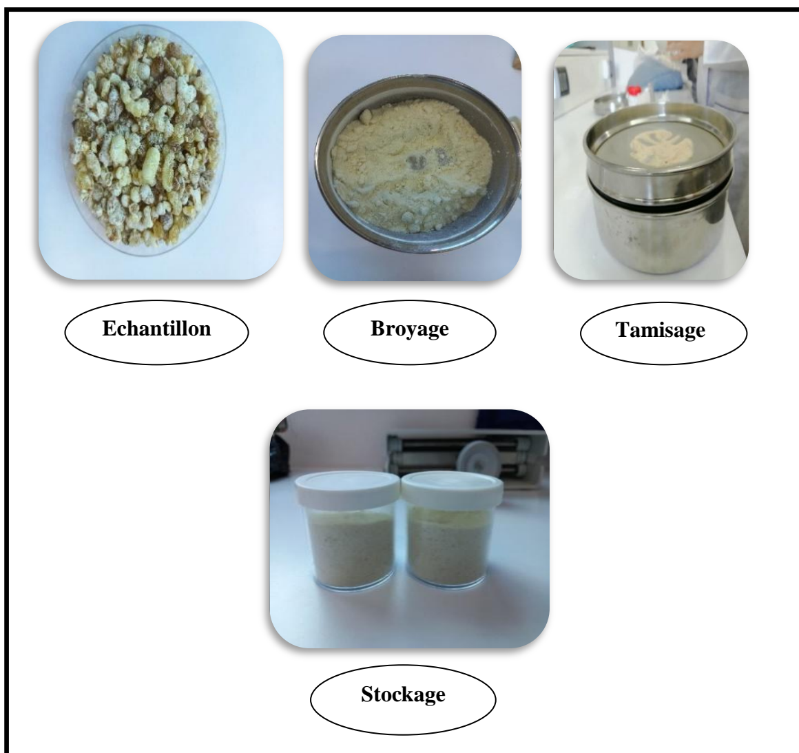
Figure 03 : Étapes de préparation de la poudre de gomme résine de Boswellia
