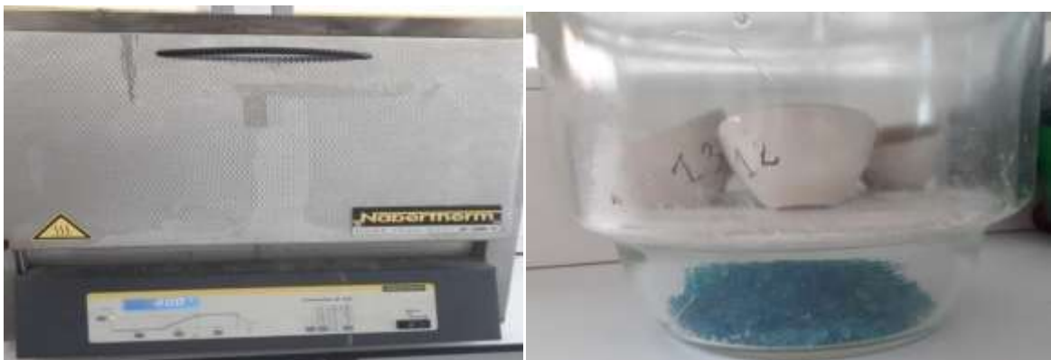
Figure 14. Le four à moufle de type Memmert, et le refroidissement dans le dessiccateur.
