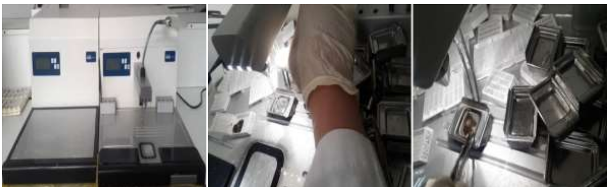
Figure 21. Appareil et technique d'enrobage dans la paraffine.
