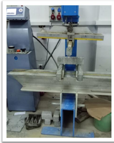
Figure III. 19: la presse hydraulique de l'essai de la traction par flexion université BBA.
