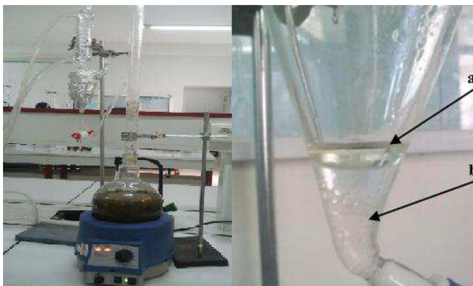
Figure 3: L'extraction des HES par hydrodistillation (clevenger). (a) Huiles essentiels d'Artemisia herba alba (b) phase aqueuse.
