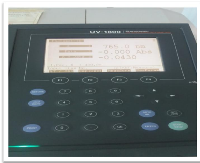
Photographie 05 : Mesure de l'absorbance à 765nm à l'aide d'un spectrophotomètre
