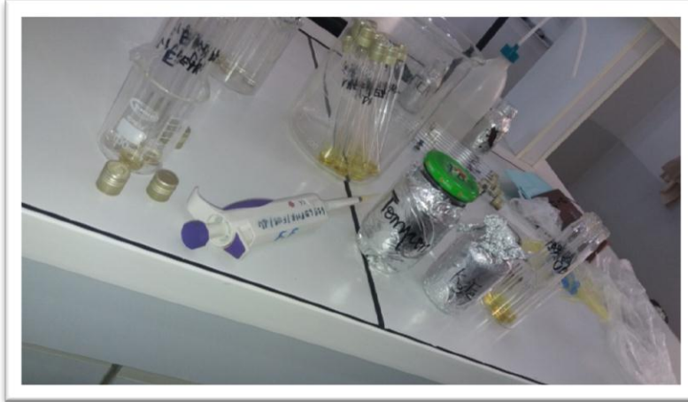
Photographie 06 : Détermination du pouvoir réducteur .
