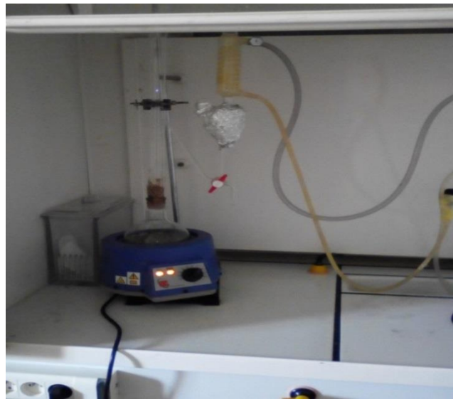
Figure 2.5: Dispositif d'extraction par hydrodistillation (Originale, 2018).
