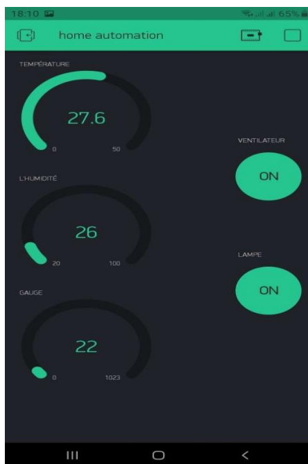
Figure III.14 :Blynk test (Temp = 27.6°, Hum = 26% et l'intensité lumineuse =22).
