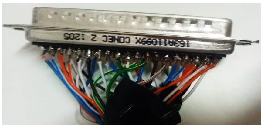
Figure 3-5 : La soudure de câble de connexion CP37
