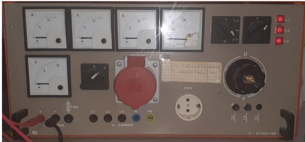
Figure 3-4 : Autotransformateur triphasé
