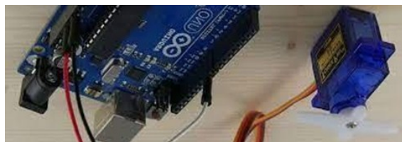
Figure III. 10 : Servomoteur avec carte Arduino
