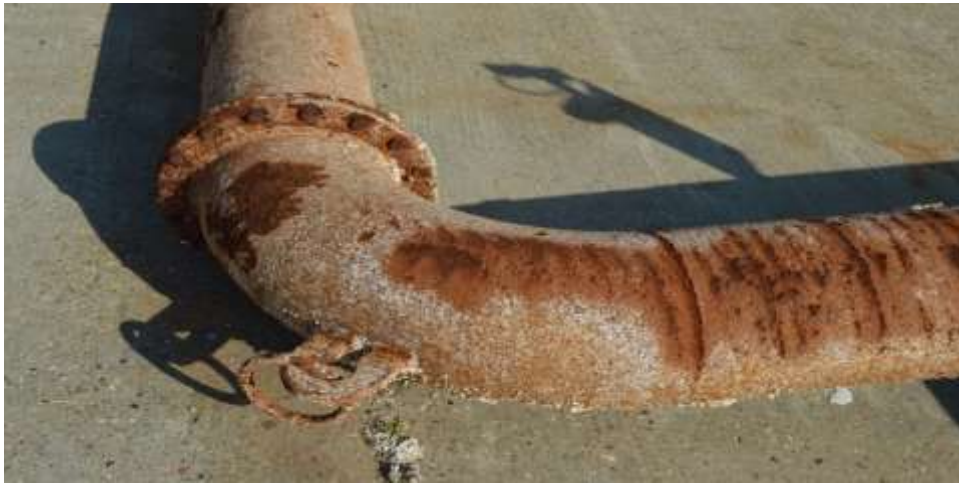
Figure I.1 : Corrosion humide de fer
