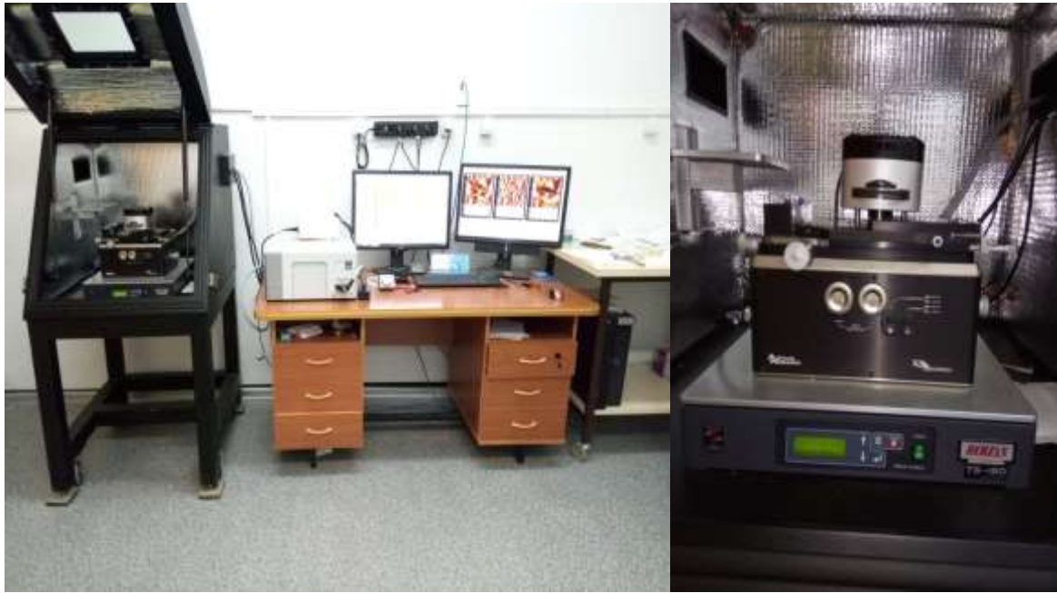
Figure II.10 : schéma d'un microscope Asylum Research MFP-3D en mode contact
