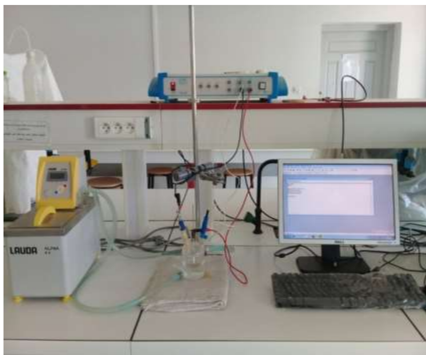
Figure II.1 : Représentation schématique du dispositif expérimental (Voltalab 40 + cellule électrochimique).
