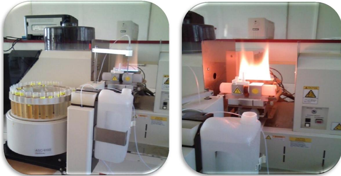
*Figure III.6. L'analyse des ETM par SAA par la technique de la flamme*
