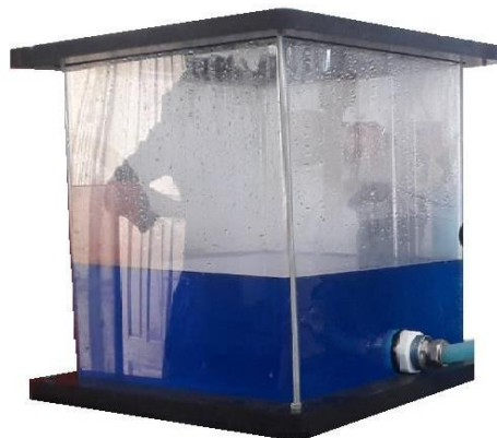
Figure II .4 : Réservoir utilisée pour la réalisation du banc d'essai.
