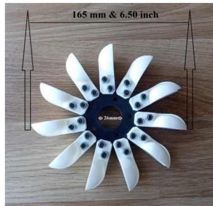
Figure II.3 : Turbine Pelton utilisée pour la réalisation du banc d'essai.
