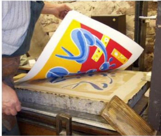
Figure I .2 : Lithographie polychrome : une impression par couleur donc une pierre par couleur Ici avec la pierre pour la couleur bleue Image ARTEnovance [7]
