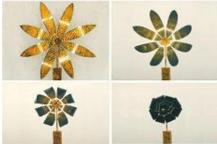
FigureII.7 : "Fleur" micro-origami à base de polymère conducteur par Smela et al. [35], [36].
