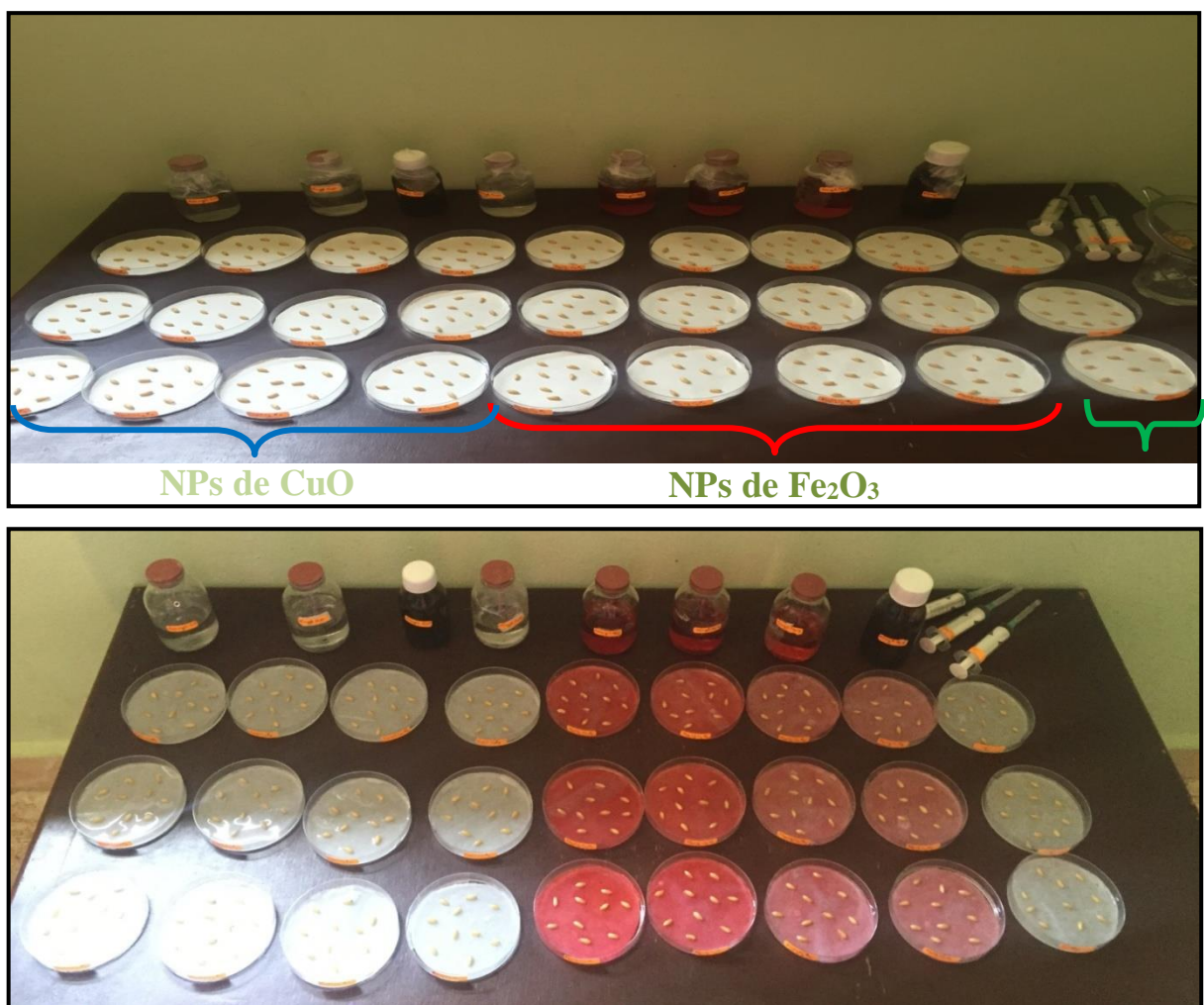
Figure 3 : Dispositif expérimental de l'essai avant et après l'arrosage (culture en boîte de pétri).
