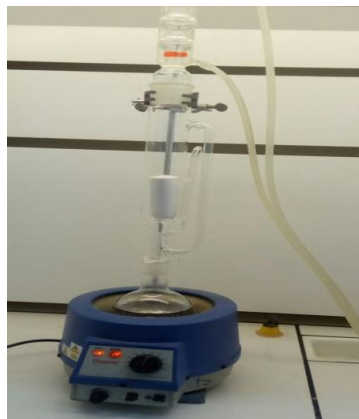
L'extraction par Soxhlet
