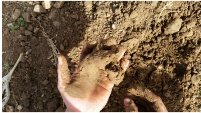
Figure 05 : Appréciation du taux d'argile (test d'élasticité).
