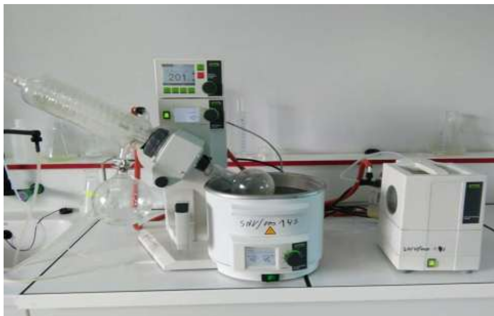
Figure 15 : Séchage de l'extrait brut à l'aide de rotavapor.
