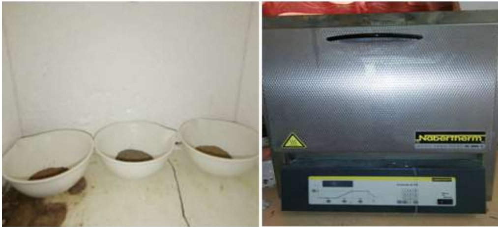
Figure 25 : Le sol dans un Four à moufle.
