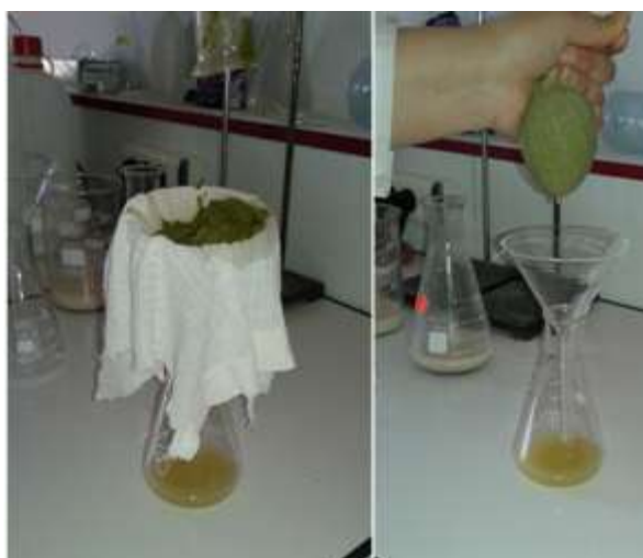
Figure 16 : Filtration à l'aide d'un tissu (mousseline).
