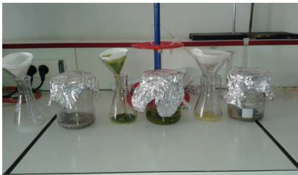
Figure 14 : Filtration des extraits avec papier filtre.
