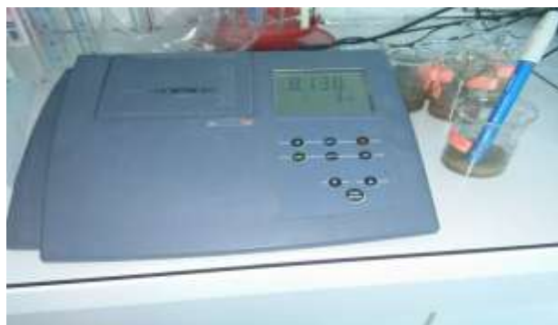
Figure 22 : la mesure de pH des trois sols.
