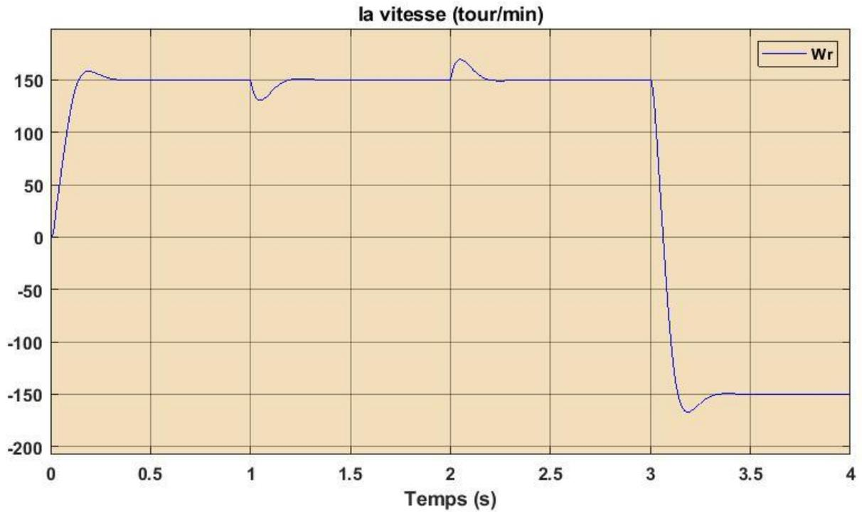
Figure( II.6) :Résultats de simulation de la commande vectorielle à vide
