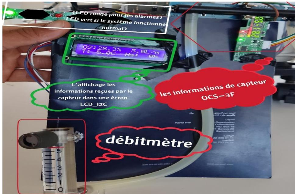
Figure 2. 3: Les afficheurs et le LEDs de la partie du commande.
