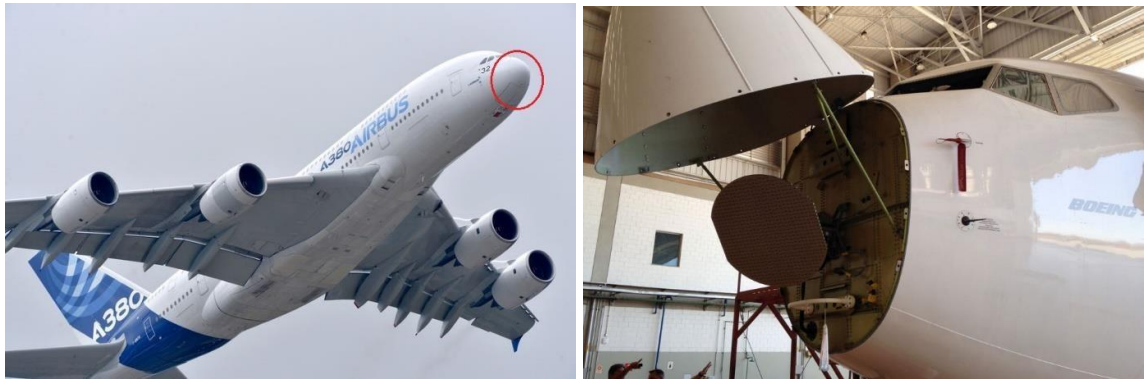
Figure.II.012. Application des FSS au radôme
