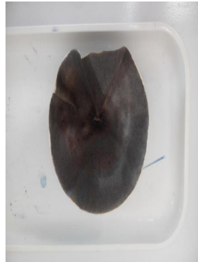
Récupération du filtre après étuvage
