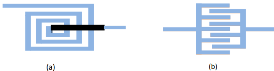
Figure I. 5. Composants localisés : (a) inductance en spirale (b) capacité inter digitées
