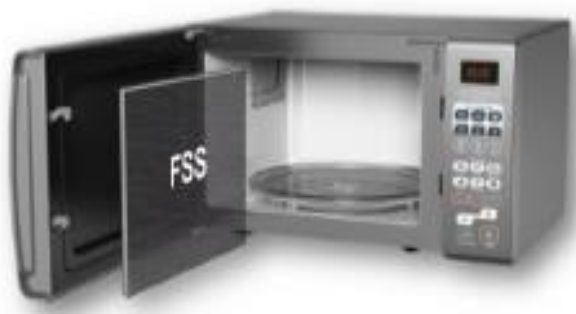
Figure II.4. Application des FSS comme un écran sur la porte du four micro-ondes
