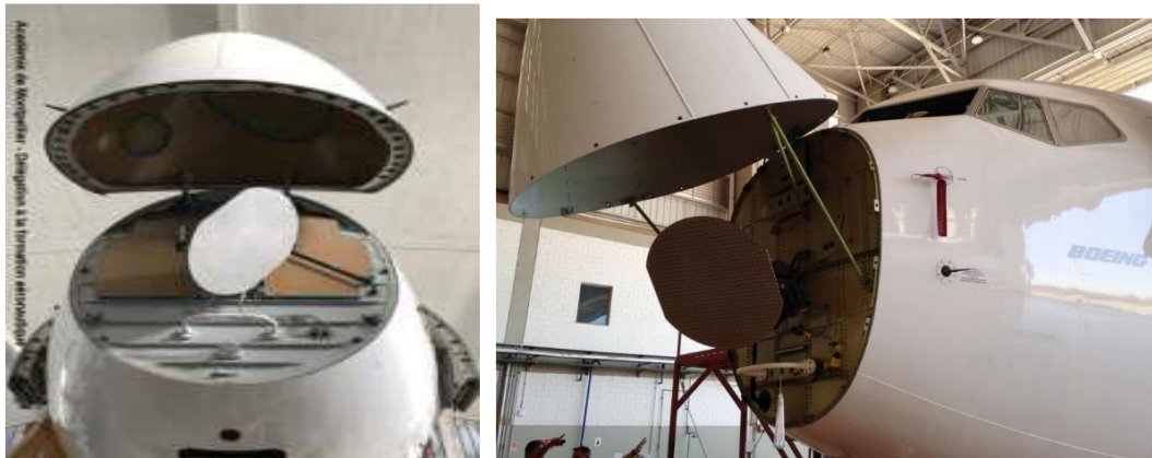
Figure II.3. Radôme en forme de cône qui une fois soulevé montre le radar d'un Airbus A320 [28]
