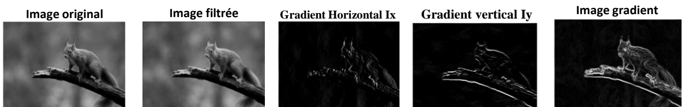
Figure 3.3 Résultats de détection de contours par Sobel ; composantes et module gradient
