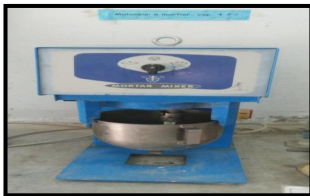
Figure II.5 : malaxeur normalisé EN 196-1.
