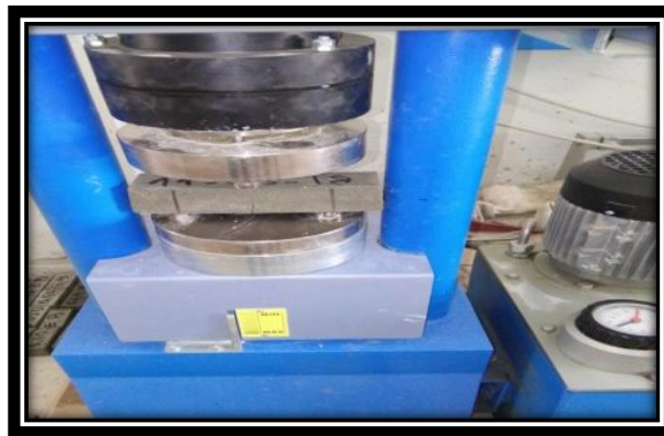
Figure. II.10 : Dispositif expérimental de l'essai de flexion
