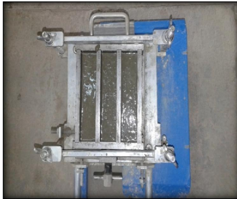
Figure 2.8. Coulage du mortier dans les moules 4x4x16.
