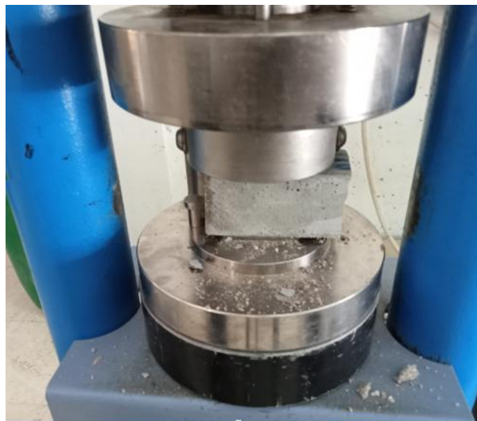
Figure 2.14. Essai et rupture en compression.
