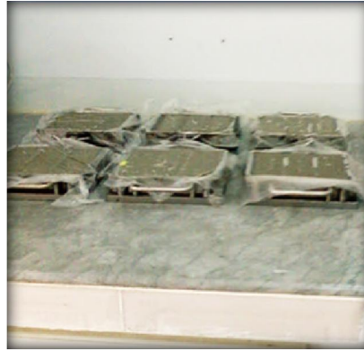
Figure 2.10. Echantillons des éprouvettes de mortiers après le coulage.
