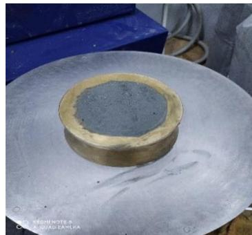
**Figure 3. 8** Le test de fluidité selon la norme ASTM C 1437–20 (C1437-20, 2020).
