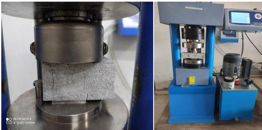
**Figure 3. 9** Appareils de l'essai de compression et de flexion.
