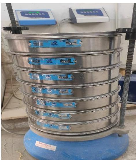
**Figure 2. 2 :** analyse granulométrique
