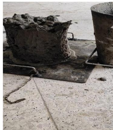
**figure2.7** : Essai réel d'affaissement au cône d'Abrams
