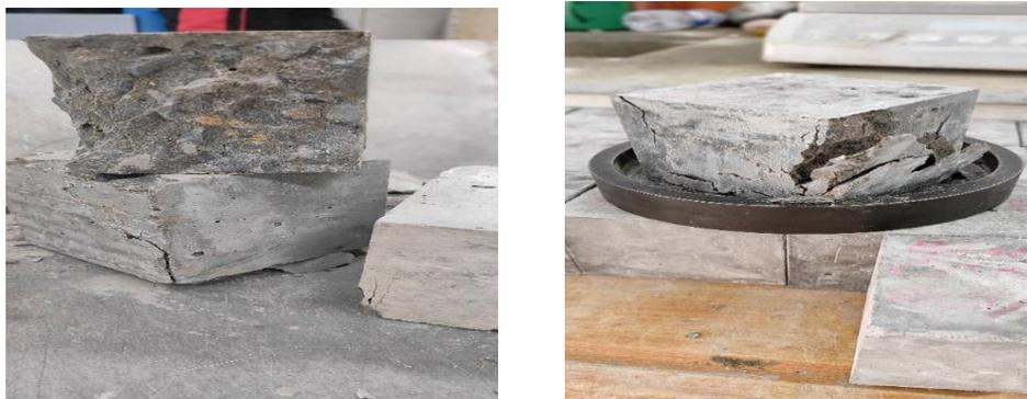
**figure2.9**: Eprouvettes cubiques (10x10x10) cm<sup>3</sup> après écrasement
