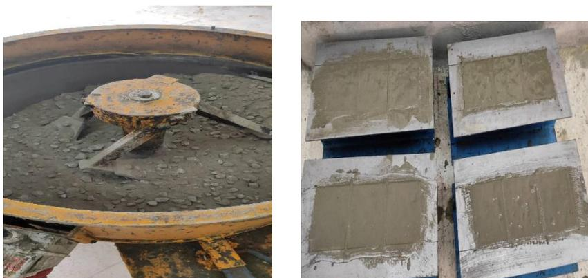
**Figure2.5 : Malaxeur et moules utilisés pendant les essais**
