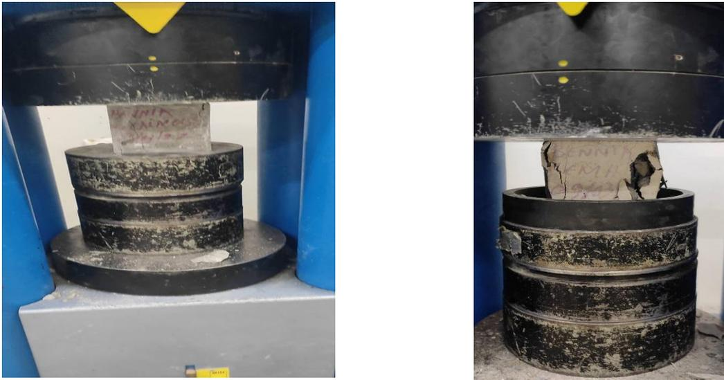
**figure2.8** : Machine d'essai de compression utilisé
