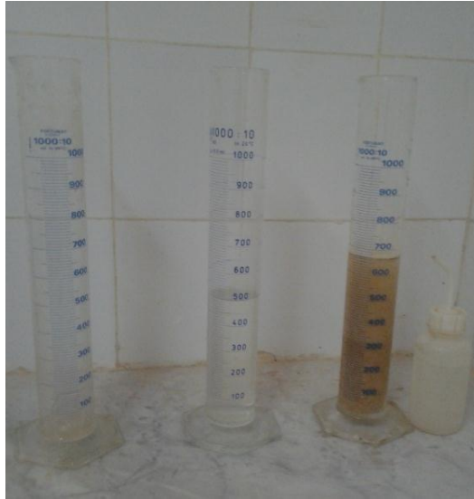
Figure 3- 6: Méthode de mesurer la masse volumique absolue.
