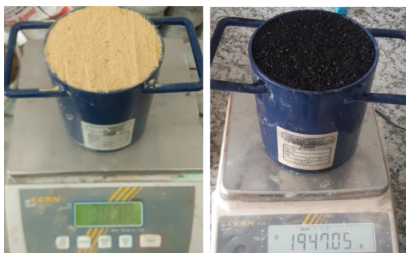
Figure 3- 7: Méthode de mesurer la masse volumique apparente.
