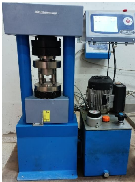
Figure 3- 16: Presse utilisée pour des essais mécaniques.
