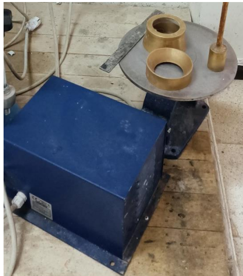
Figure 3- 15 : table à choc pour l'essai d'étalement.
