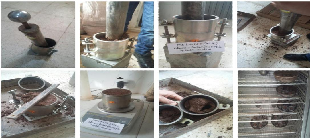
Figure 2.9. Essai Proctor Normal de la terre.
