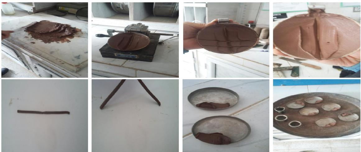
**Figure 2.8.** Essai de limite d'Atterberg.
