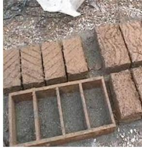
**Figure 1.3.** Production manuelle des adobes avec un moule en bois [9].
