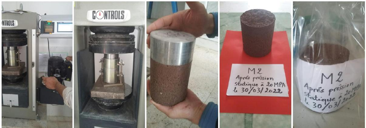
**Figure 2.12.** Compactage statique de la terre.
