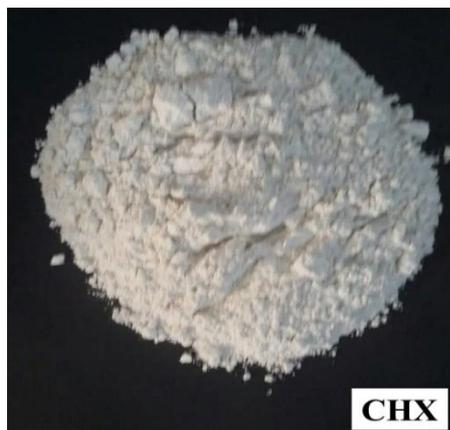
**Figure 2.2.** Echantillon de la chaux.
