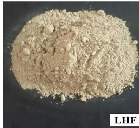
**Figure 2.3.** Echantillon de laitier de haut fourneau (LHF).
