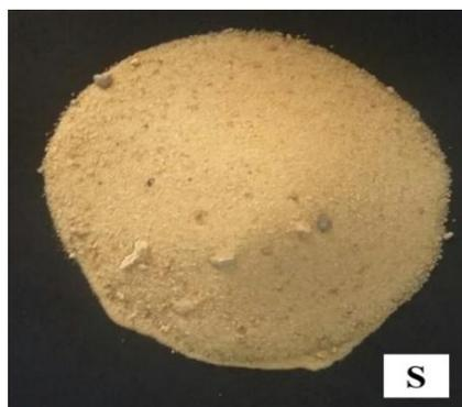
**Figure 2.4.** Echantillon de sable de dune.
