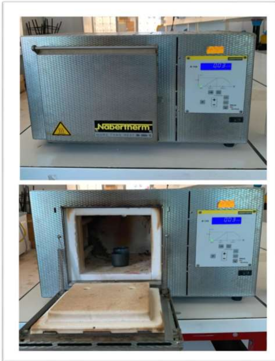
Figure II.4 four NABERTHERM (30 à 3000 °C) utilisé pour frittage.
