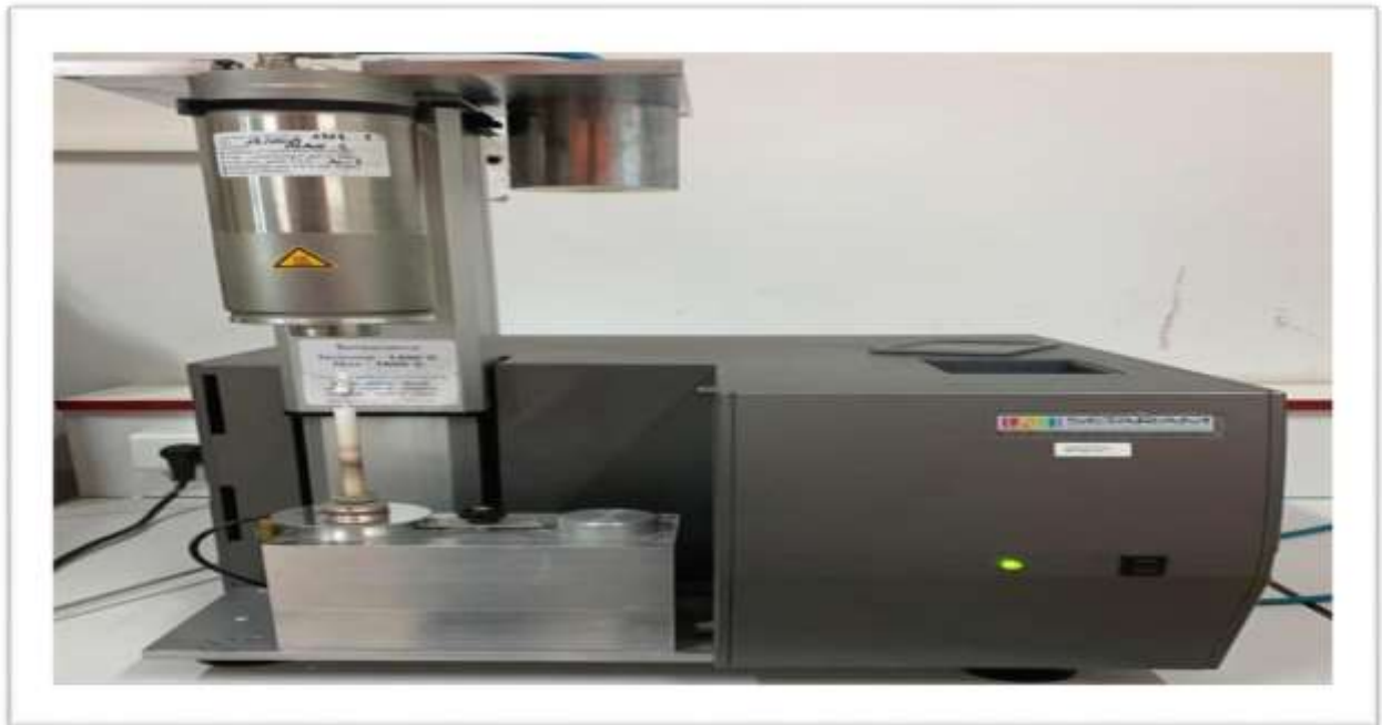
Figure II.6 : Appareil d'analyse thermogravimétrique (ATG).
