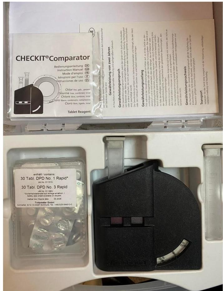
Appareil utilisé pour la détermination de taux de chlore (CHECKIT comparator).i
