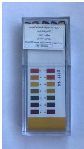
Papier pH utilisé pou la mesure de pH.
