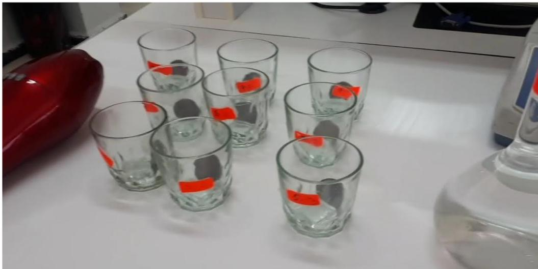
**Figure II.6:** Les 9 pièces immergées dans les béchers contenant la solution d'acide chlorhydrique et l'inhibiteur.
