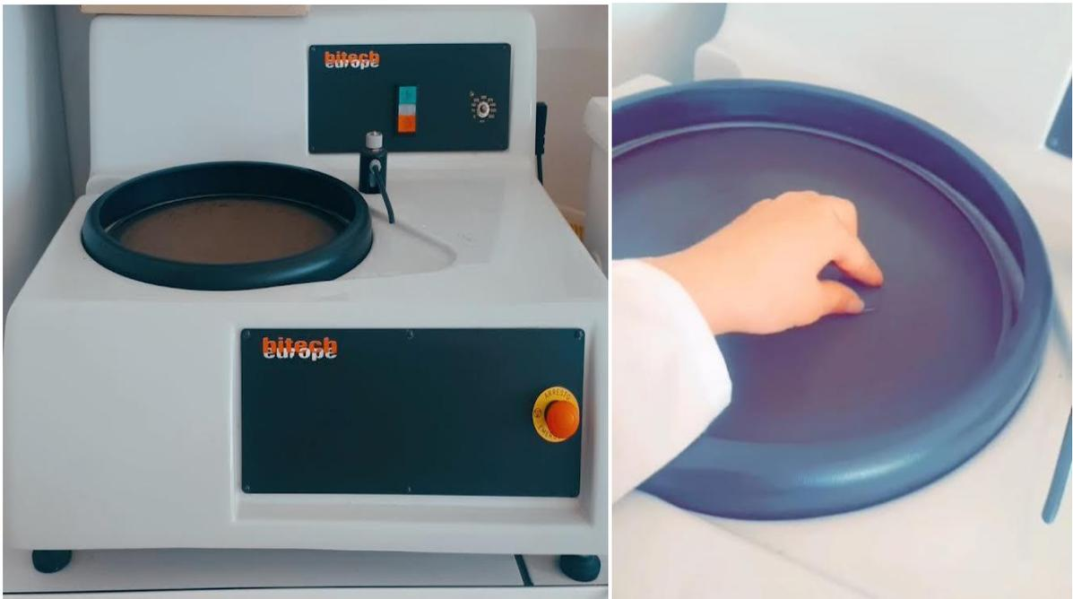
Figure II.3: Polisseuse mécanique
