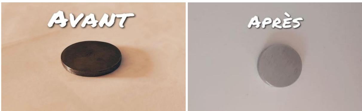
Figure II.4 : Echantillon d'acier XC48 avant et après le polissage.
