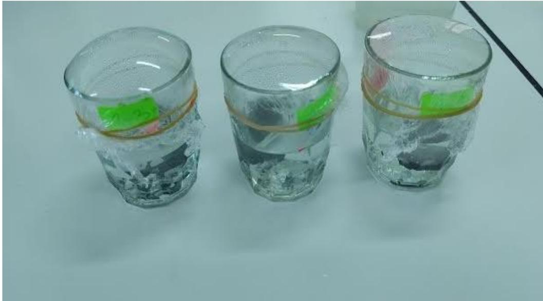
**Figure II.7 :** Echantillons immergés couverts avec un film en plastique
