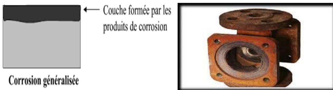
Figure I.3: corrosion uniforme ou généralisée.
