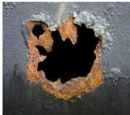
Figure I.7 : La corrosion par piqûres.
