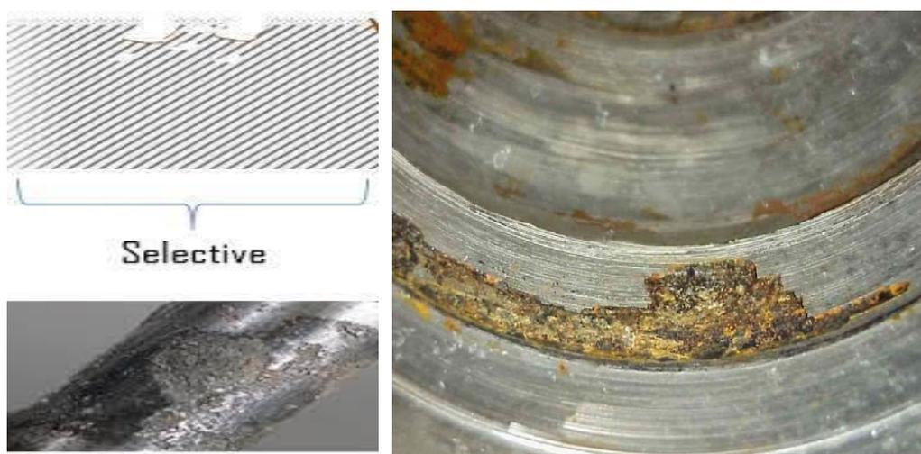
**Figure I.10** : Corrosion sélective.
