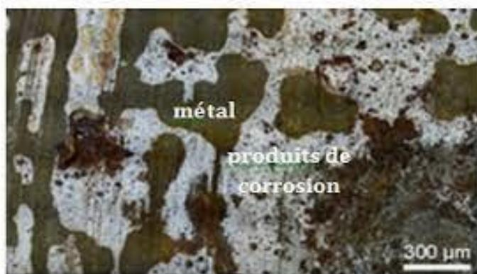
**Figure I.16 :** Effet de bactéries sur la corrosion d'un acier.
