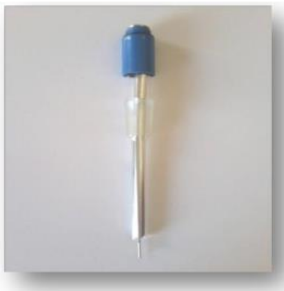
Figure II.3: Schéma de l'électrode de travail.
