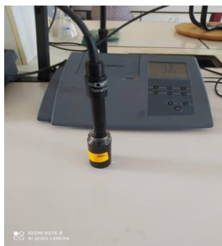
Figure III.12 : L'appareil de mesure de conductivité
