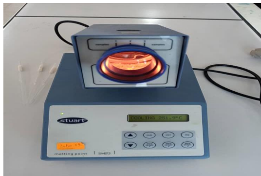
Figure III.10: L'appareil fusiomètre à capillaire utilisée pour déterminer le point de fusion.
