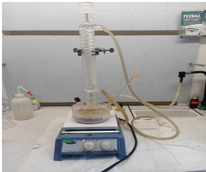
Figure II.1. Montage de la synthèse de complexe L-FeCl 2 .
