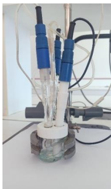
Figure II .12. Montage d'une cellule électrochimique à 3 électrodes connectée sur un potentiostat.
