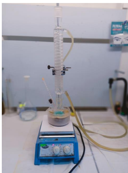
FigureII.3.Montage de la synthèse de complexe L-Cu.
