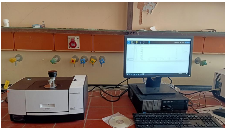
Figure II.10. Schéma d'appareil de l'infrarouge (IRSpirit).
