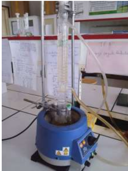
Figure II.4 : Montage expérimentale utilisé dans la réaction de chlorosulfonation du PS par l'acide chlorosulfonique
