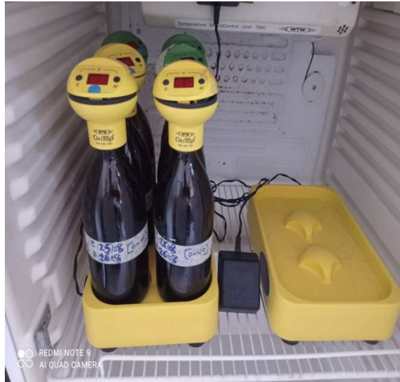
Photo N°7 : Flacons de mesure de DBO 5 .
