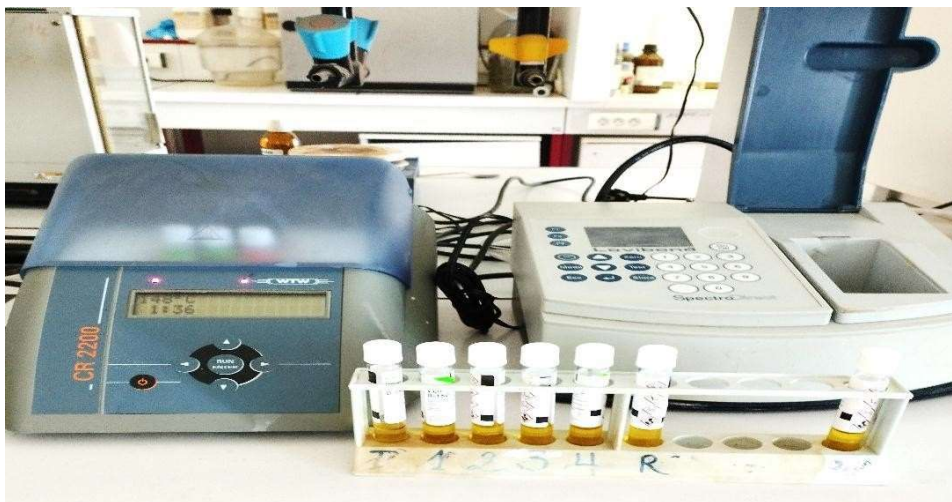
Photo N°6 : Réacteur thermique préchauffé et spectrophotomètre pour la mesure de la DCO.
