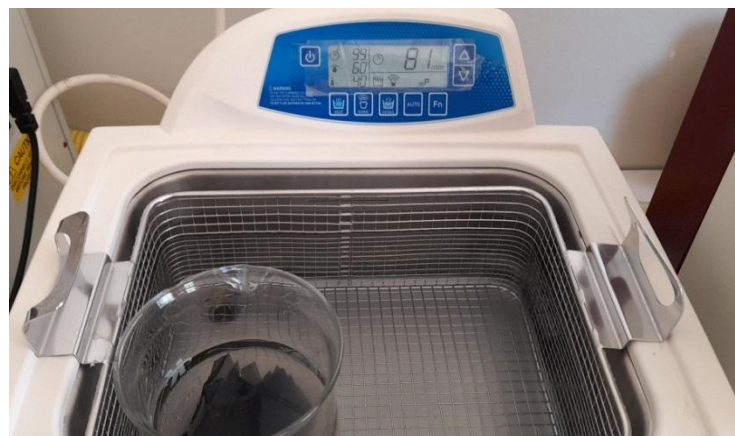
Figure III.2. : Extraction de l'indium et de l'étain dans un bain ultrasons.
